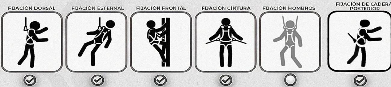
Según la referencia de los equipos, los puntos de conexión estarán señalados con un signo de visto y estarán resaltados los pictogramas, según sea el caso (etiqueta de conexión).
