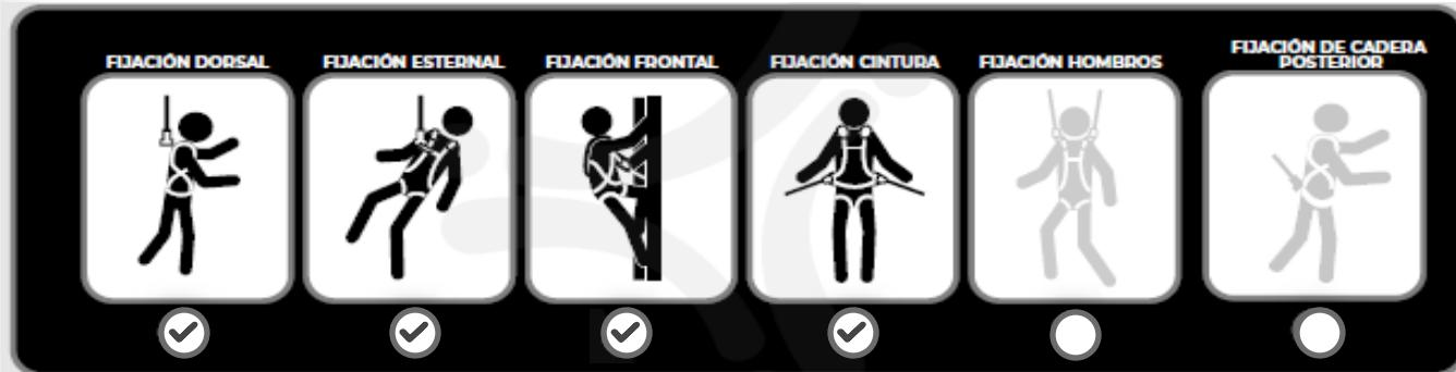
Según la referencia de los equipos, los puntos de conexión estarán señalados con un signo de visto y estarán resaltados los pictogramas, según sea el caso (etiqueta de conexión).
