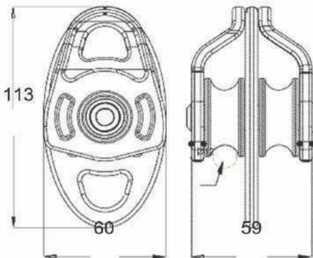
Resistencia mínima a la rotura (MBS) de 35 kN, Carga utilización máxima (WLL) 7 kN, Para uso de cuerda máximo 11 mm, Modelo S EPI categoría III, Dos bridas exteriores fijas de 79mm de alto y 60mm de ancho y una brida central fija de 113mm de altura
