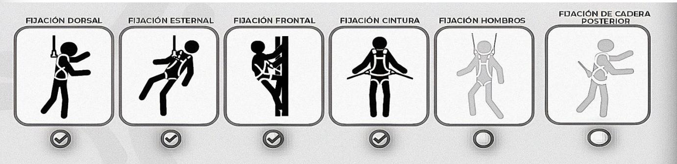
Según la referencia de los equipos, los puntos de conexión estarán señalados con un signo de visto y estarán resaltados los pictogramas, según sea el caso (etiqueta de conexión).
