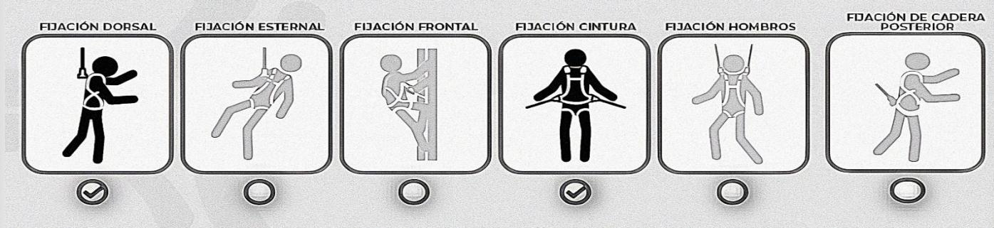
Según la referencia de los equipos, los puntos de conexión estarán señalados con un signo de visto y estarán resaltados los pictogramas, según sea el caso (etiqueta de conexión).
