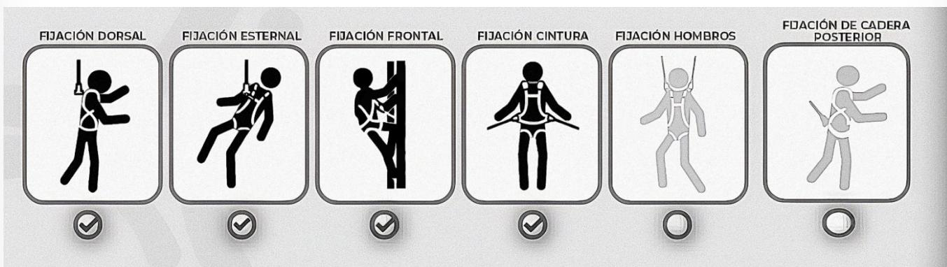
Según la referencia de los equipos los puntos de conexión estarán seleccionados con un signo de visto y estarán resaltados los pictogramas según sea el caso, (etiqueta de conexión)
