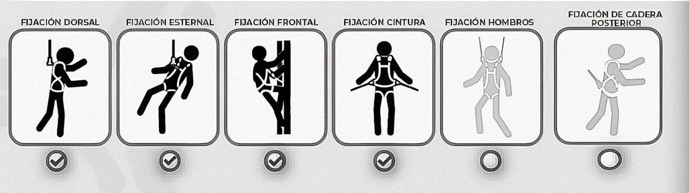
Según la referencia de los equipos, los puntos de conexión estarán señalados con un signo de visto y estarán resaltados los pictogramas, según sea el caso (etiqueta de conexión).
