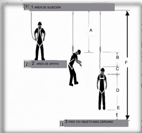
Fig. 1 - Requisito mínimo de claridad: línea de vida con amortiguación de impactos de 6 pies. Medida desde el conector de anclaje superior
